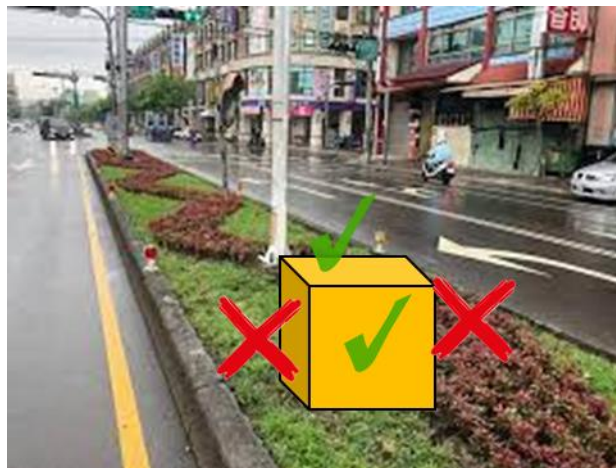
圖4.5.3.1-2 迴路控制箱開門方向設計
