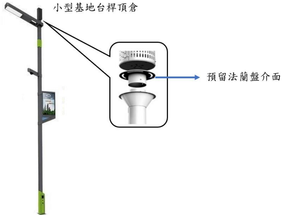
圖 A.1 小型基地台杆頂倉示意圖
