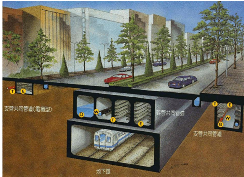
圖4.6.2.2-1共同管線及分歧部示意圖(參考”松山線共同管道工程規劃設計理念”)
